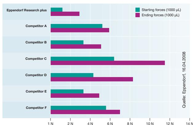
● Die Pipettierkraft wurde zur Reduzierung der Belastung minimiert.
